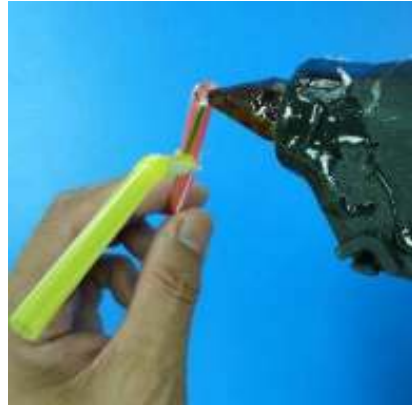
圖 7. 用熱熔膠將簡易塑膠吸管上端封閉
